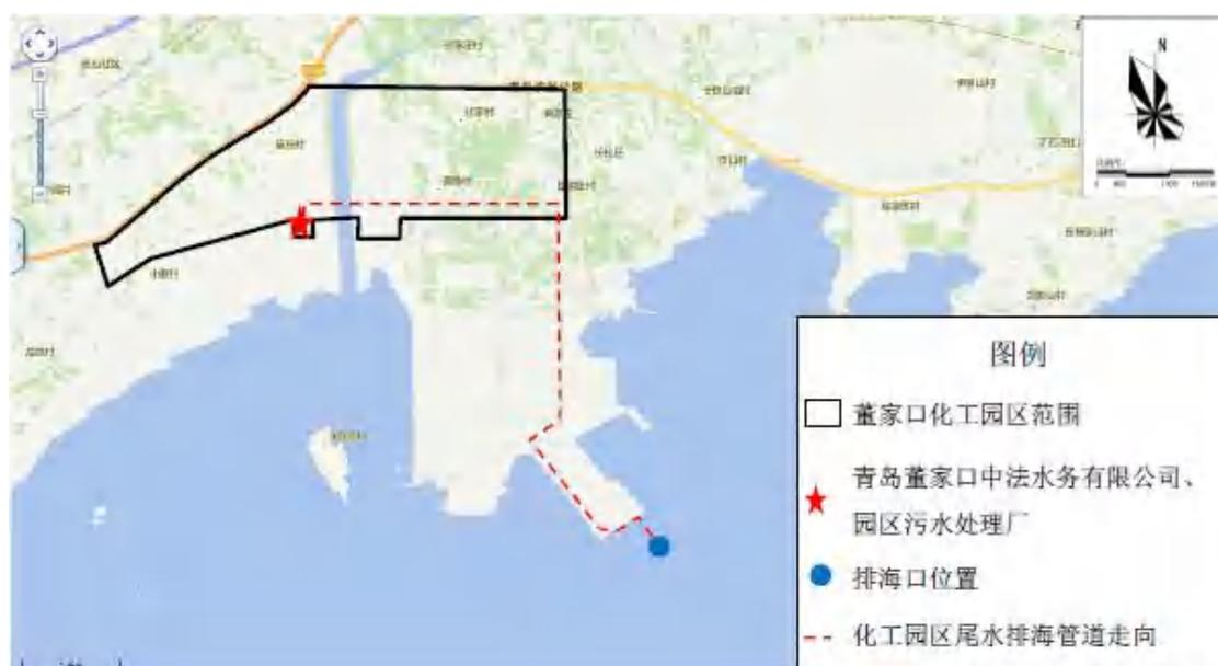
图8.2-1 董家口化工园区规划环评中给出的污水排放管道走向及排污口位置图
